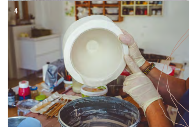
3 Wenn die Farbe angetrocknet ist, wird die Porzellanmasse in die Form gegossen. 4 Die Trockenzeit bestimmt die Dicke der Schalenwand.
